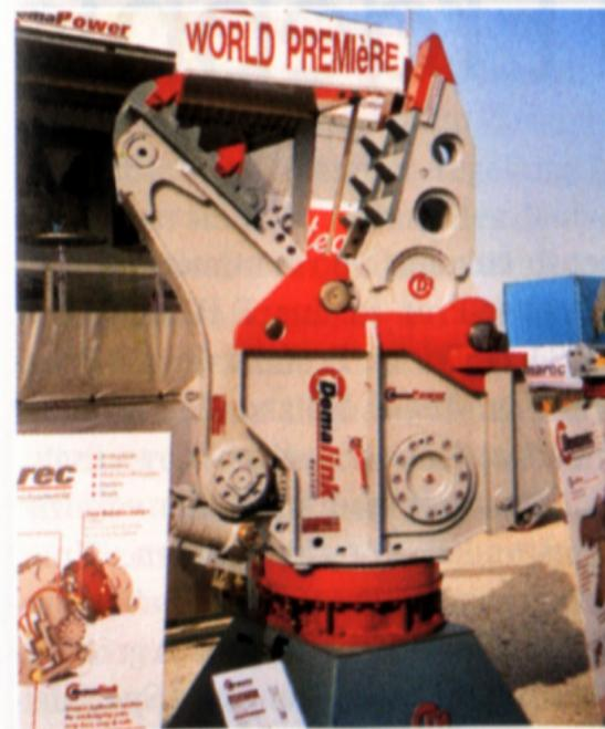
**Zahnersatz:** Die Besonderheit des neuen „Multi-Quick-Prozessors“ für den Abbruch von Beton- oder Stahlkonstruktionen sind die per Schnellwechselsystem austauschbaren Backen. Dazu kommt die neuartige Zylinderkonstruktion für hohe Schließkräfte und schnelle Backenbewegungen.
